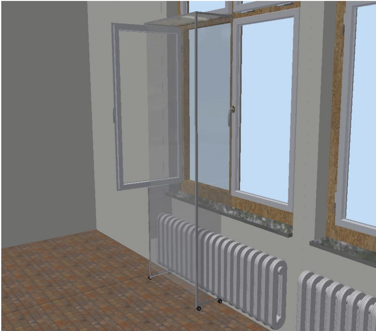
Abbildung 4: CAD Modell eines beweglichen (rollbaren) Vorbaus, gebaut aus Polycarbonat Doppelstegplatten, Alu-Eckprofilen und Möbelrollen zur Denkmalschutz-, Wärmeschutz- und Behaglichkeitskompatiblen Einleitung der Frischluft von einem Drehfenster auf den Boden. Das Fenster bleibt voll funktionsfähig und kann außerhalb der Unterrichtszeit geschlossen werden, so dass kein zusätzlicher Wärmeverlust entsteht.
