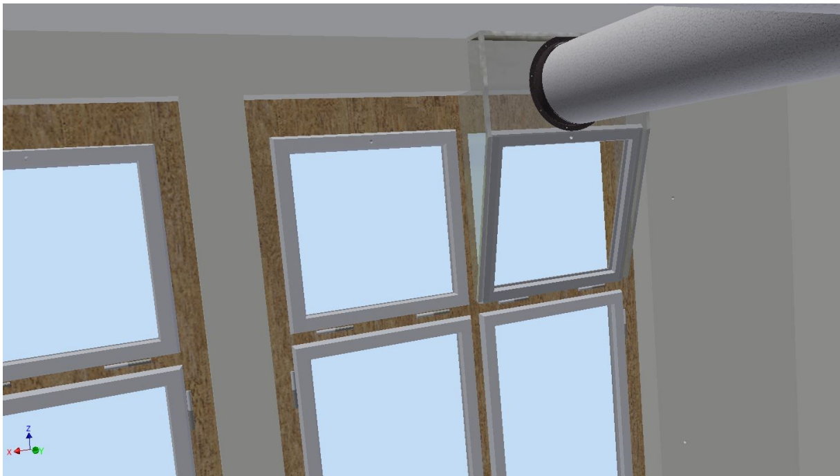
Abbildung 3: CAD Modell einer Ventilatorbox, gebaut aus Polycarbonat Doppelstegplatten und Alu-Eckprofilen für Denkmalschutz- und Wärmeschutz kompatiblen Anschluss des Abluftventilators an ein Kipfenster. Das Fenster bleibt voll
